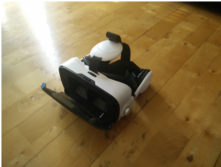
Abbildung 3.1: Die für die Durchführung der Nutzerstudie genutzte Halterung zur Nutzung eines Smartphones als HMD.
