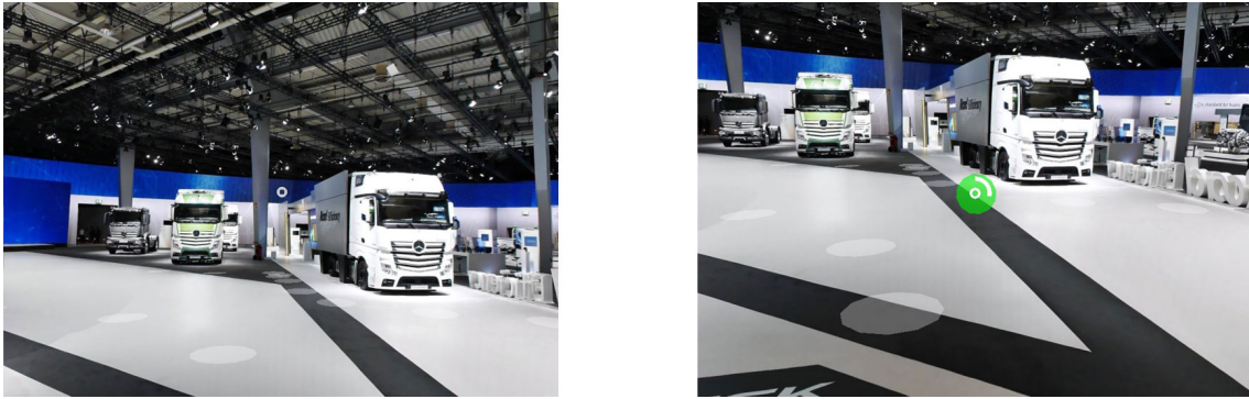
Abbildung 3.5: Die für den Prototypen genutzte Anzeige zur Steuerung mittels Blickrichtung. Der graue Kreis in der Mitte des Blickfelds zeigt den Cursor, wenn kein Objekt vom dahinterliegenden Raycast geschnitten wurde (links) und den Ladebalken zur Auslösung der Bewegung, falls ein Objekt geschnitten wurde (rechts).
